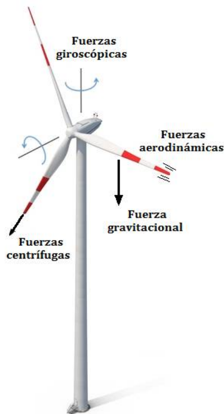
Figura 1.5. Fuerzas presentes en un aerogenerador.
